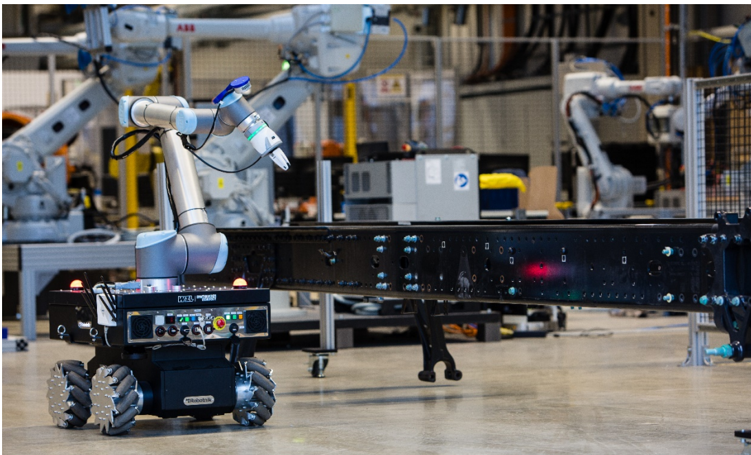
Bild 2: Mobiler Roboter als Automationsressource in der Linienlosen Montage eines LKW Rahmens
